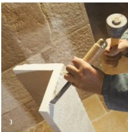
1. Barrettes sciées usées | 2. Façade en Auberoche Corbières | 3. Travail de l'angle évidé | 4. Façade commerce en Auberoche claire | 5. Façade en Abbaye d'Auberoche
